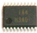
ルネサステクノロジ社製マイコン R5F211A4SP 搭載
